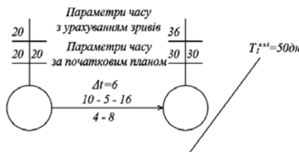
Рис. 5. Приклад запису параметрів часу мережевого графіка з урахуванням зривів до лінії знімання інформації
